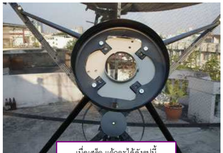
ประกอบก้านยึด LNB ทั้ง 4 ก้านเข้ากับจาน (จะใส่ก่อนหรือหลังยกสวมนเสาก็ได้)
