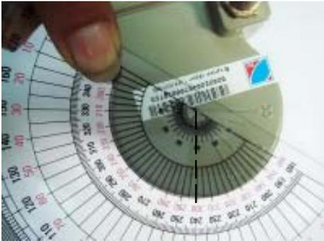
นำเครื่องมือช่วยปรับโพลาริไทท์มาวางบน LNB โดยค่า 180 อยู่ในแนว 0 ของ LNB และทำการขีดเส้นค่า 240 กับ ตัว LNB ( ค่า 240 คือ ค่ามุมสายของจานดาวเทียมที่รับดาวเทียมไทยคม )
