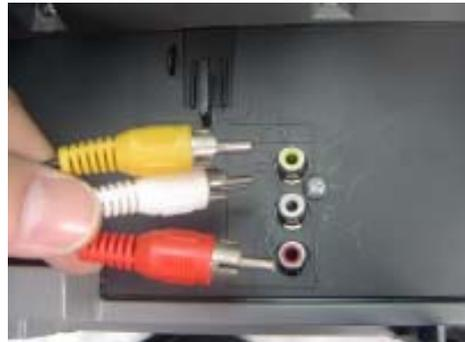
สายอีกด้านไปต่อเข้าที่ AV in ของทีวี โดยหัวสีเหลืองต่อเข้า Video ส่วนหัวสีขาวกับสีแดง ต่อเข้า L กับ R (การต่อด้วยสาย AV เข้ากับทีวีผู้ติดตั้งไม่ต้องจูนช่องทีวี)
