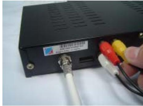
ต่อสาย AV Out มีสาย 3 เส้น โดยหัวสีเหลืองต่อภาพ ส่วนหัวสีขาวกับแดง ต่อเสียง ซึ่งเป็นสัญญาณซ้าย และขวา stereo
